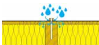
Mocowanie kontrłat bez uszczelnienia.
