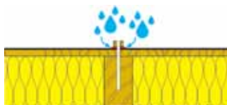
Uszczelnienie kontrłat – wilgoć nie przenika.
